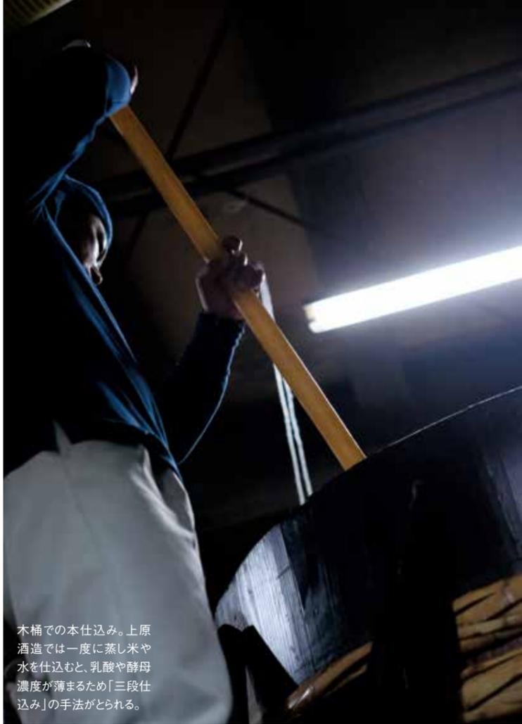
木桶での本仕込み。上原酒造では一度に蒸し米や水を仕込むと、乳酸や酵母濃度が薄まるため「三段仕込み」の手法がとられる。
